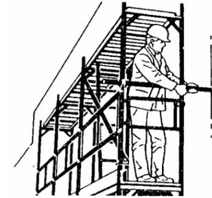
7 Monter les garde-corps latéraux nécessaires et fixer l'échafaudage de façade conformément au schéma d'ancrage prescrit avant de procéder au montage des cadres de passage du niveau suivant.
