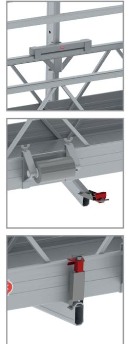
14. Setzen Sie die Geländer in die Geländerpfosten und sichern Sie sie mit den Sicherungsstiften. Sichern Sie die Verbindungsstifte mit den roten Sicherungsclips.
